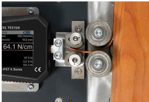
Messung kann gestartet werden; das Prüfstück wurde korrekt eingelegt
