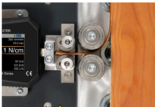
Die Messung kann nicht gestartet werden; die Kante am Prüfstück ist zu lang
